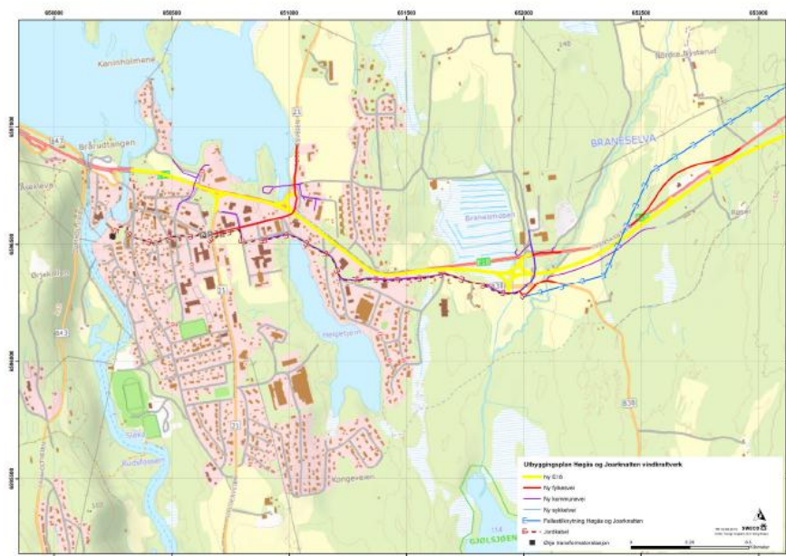
Figur 1-2 Jordkabeltrase (vist i større format i vedlegg 1.2)
